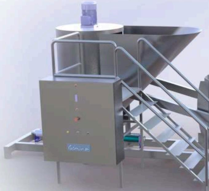
Conforme el producto cambia su estado a líquido, una bomba de rotor positivo con un sinfín alimentador envía el producto al calentador que termina de deshacer el producto.
